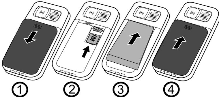
1. Retirez la trappe de la batterie et dégagez la batterie si elle est installée.
