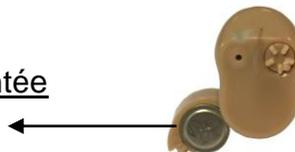
3. Positionner le mini tournevis (fourni) pour régler le volume souhaité : pour mettre en position OFF ou diminuer le volume, tourner dans le sens des aiguilles d'une montre. Pour augmenter le volume, tourner dans le sens inverse.
