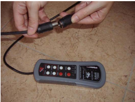
Conexión mando de control
