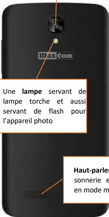
Une **lampe** servant de lampe torche et aussi servant de flash pour l'appareil photo
