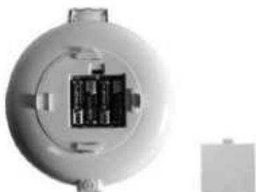
Insérez correctement les piles (4 AA) dans le compartiment à piles.
