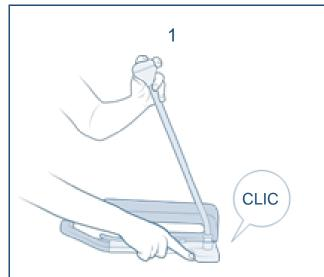
Placer le Sockee sur une surface stable. Insérer l'embout de la poignée à l'emplacement prévu jusqu'au « clic ». Ne pas appuyer sur le bouton.
