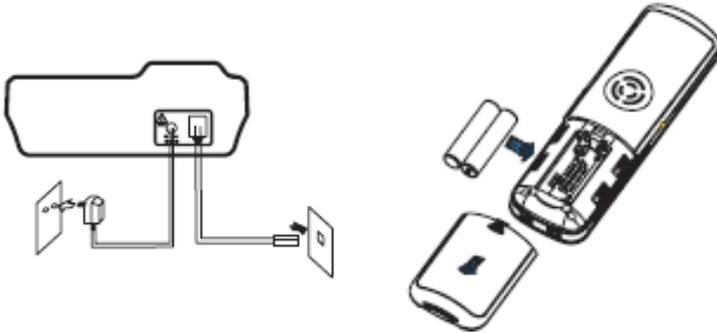
Insérez les batteries (fournies) dans le compartiment à piles du combiné en respectant la polarité et replacez le couvercle. Pour ouvrir le couvercle, tirez-le vers le bas en suivant le sens de la flèche.
