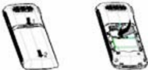
Repérez les points de charge de la batterie (La couleur dorée des points de charge doit être orientée vers le haut à gauche) puis insérer la batterie.
